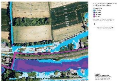
Abb. 3: Überflutungstiefe bei Starkregen (extrem, verschlammmt)
