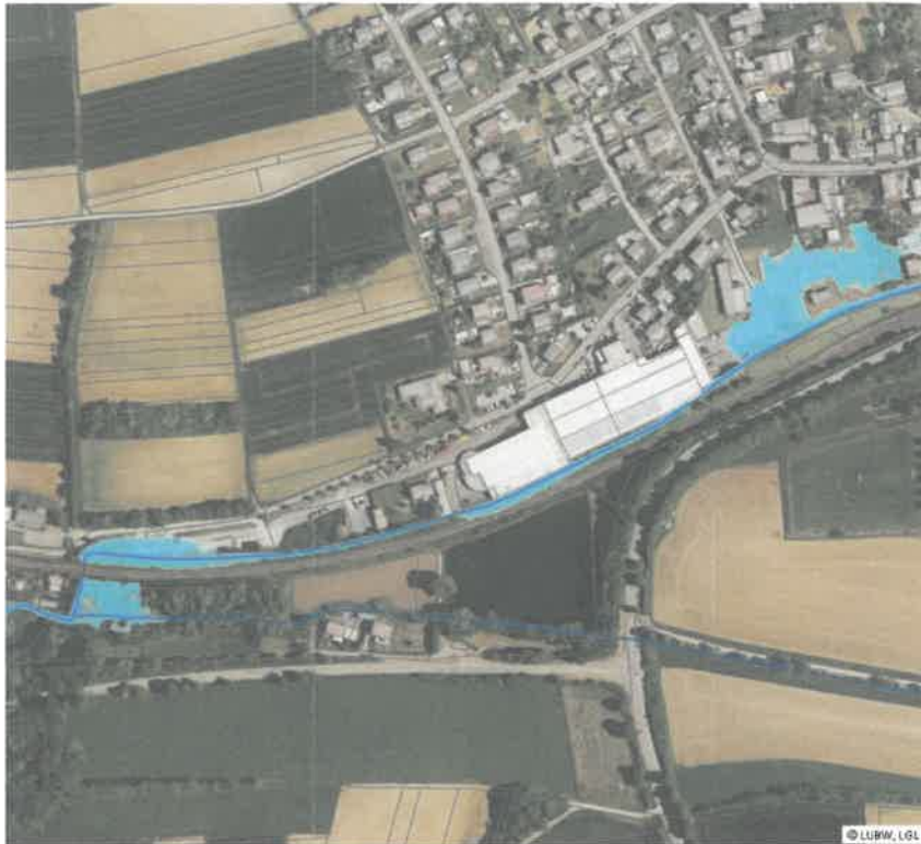
Abb. 1: Überflutungsflächen bei HQ 100 und HQ extrem
